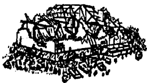
Dégâts de niveau 5
