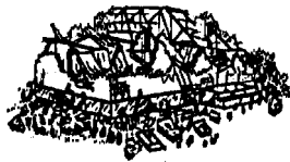
Dégâts de niveau 5
