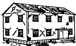
Dégâts de niveau 3
