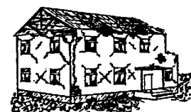
Dégâts de niveau 4
