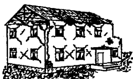
Dégâts de niveau 4
