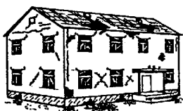
Dégâts de niveau 3
