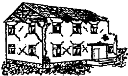
Dégâts de niveau 4
