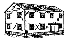
Dégâts de niveau 3
