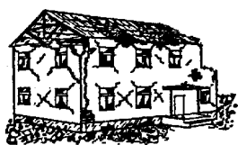
Dégâts de niveau 4
