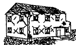
Dégâts de niveau 4
