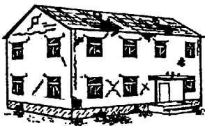
Dégâts de niveau 3
