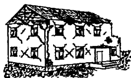
Dégâts de niveau 4
