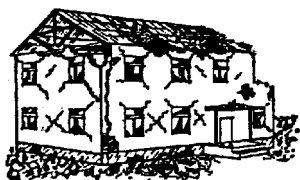
Dégâts de niveau 4
