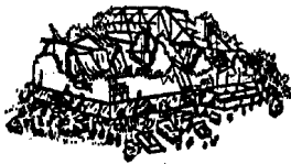
Dégâts de niveau 5
