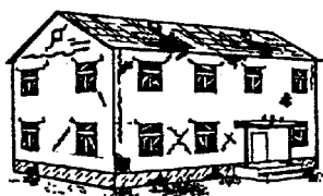
Dégâts de niveau 3
