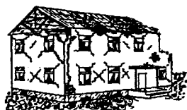
Dégâts de niveau 4
