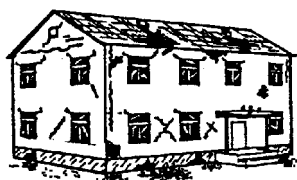
Dégâts de niveau 3
