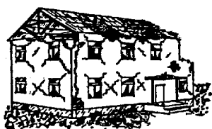
Dégâts de niveau 4
