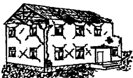
Dégâts de niveau 4
