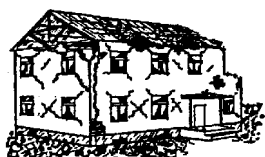
Dégâts de niveau 4
