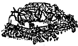
Dégâts de niveau 5
