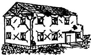
Dégâts de niveau 4
