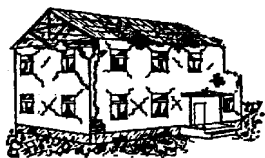
Dégâts de niveau 4
