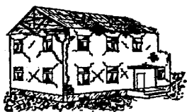
Dégâts de niveau 4
