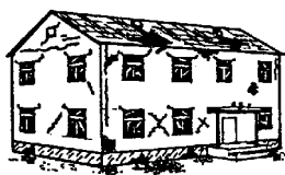
Dégâts de niveau 3
