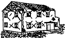
Dégâts de niveau 4
