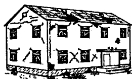
Dégâts de niveau 3
