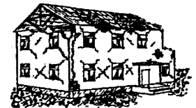
Dégâts de niveau 4
