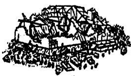
Dégâts de niveau 5
